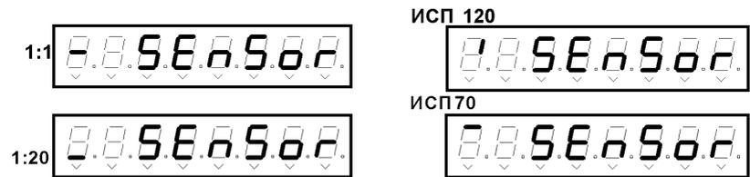
Вход в режим установки типа вертушки из меню **SENSOR** – нажатием кнопки **Кн2**. При этом в крайней левой позиции под символом, указывающим на тип вертушки, появляется курсор. Последовательным нажатием **Кн3** (перебор) выбирается требуемый тип.
