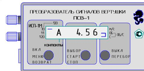
5.2. Конструктивно ПСВ выполнен в пластмассовом корпусе с крышкой, в котором размещены печатная плата с электронными элементами, жидкокристаллический дисплей, два гальванических элемента для электрического питания ПСВ.
